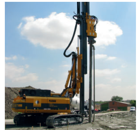
RG 19 T mit Rüttler MR 105V RG 19 T with vibrator MR 105V
