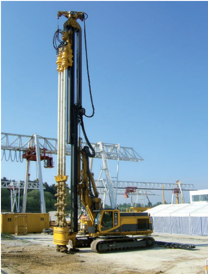
SMW-Ausrüstung mit Dreifachantrieb an RG 16 T SMW attachment with triple drive on RG 16 T
