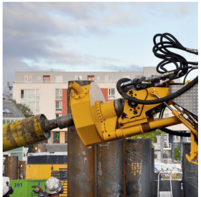
Bohrantrieb für DTH (schwenkbar) Rotary drive for DTH (turnable)
